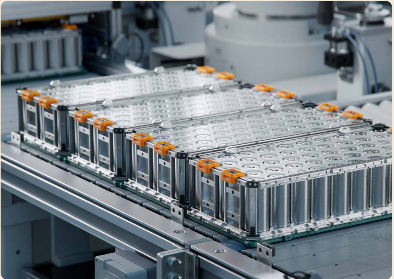
Lithium-ion-hoogspanningsbatterijcomponent voor elektrische voertuigen of hybride auto's in de productielijn.
